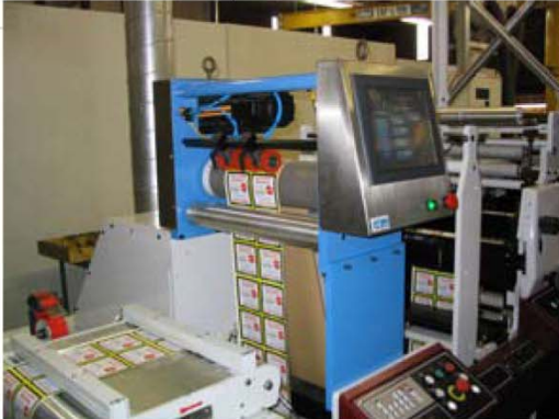
2ウェブ給紙のマークアンディ LP3000 機に搭載した事前印刷済みウェブとの見当合わせと加工見当を統合したシステム
