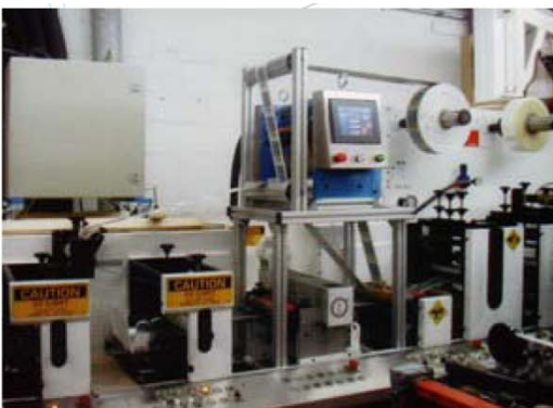
印刷済みウェブの貼り合せ用に搭載され、クーポン、ブックレットラベルやキャンペーンシール等を容易に生産するよう制御できます。 アクアフレックス InstaPrep
