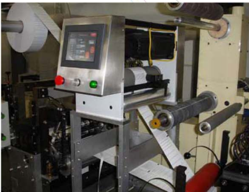
2枚の印刷済み用紙を、搭載印刷機で印刷中のもう1枚のウェブに見当合わせを行ないながら貼り合わせる目的で搭載された例です。 ガルス EM340機
