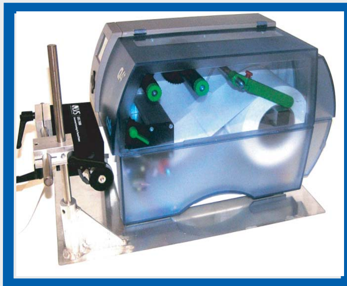
プリンター本体とメカニカル接続のないフリースタANDING型読み取り装置
