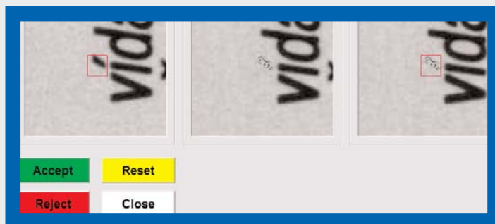
運転中にプレミッシュエラー表示画面：許可/不許可設定も可能
